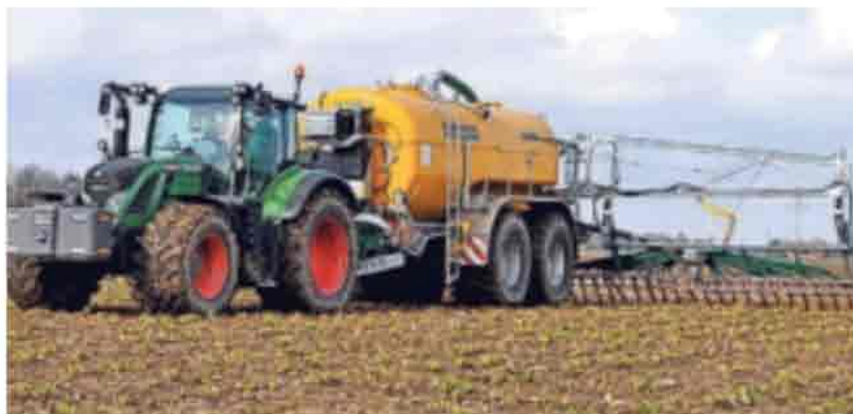
Gülle wird heutzutage nicht mehr großflächig mit einem so genannten „Prallteller“, sondern über einen „Schleppschuhverteiler“ auf den Feldern verteilt. Dabei wird die Gülle durch viele kleine Schläuche direkt in den Boden gebracht und damit die Geruchsbelästigung deutlich minimiert. Foto: Stefan Bercks
